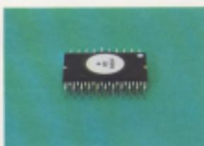
Die hochmoderne **Elektronik von morgen** mit nur einem MOS/LSI-Chip neuester Technologie-Stufe zeichnet den Olympia CD 603 besonders aus; er ist die Basis für die hervorragende Rechenleistung.
