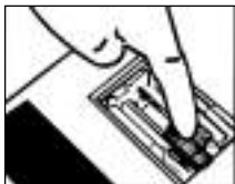
3. Neue Farbrolle einsetzen
